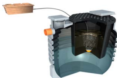
Τομή της δεξαμενής του αντιδραστήρα BioKompact
